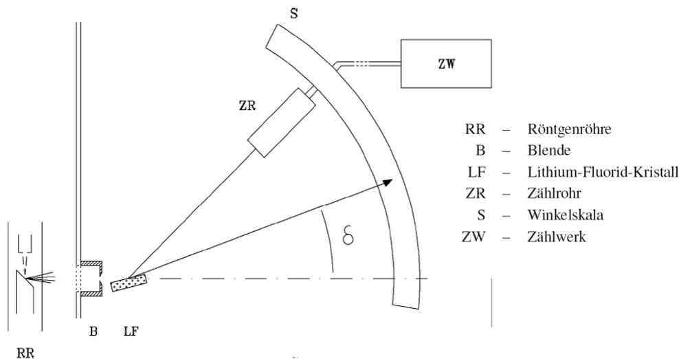
In einer Röntgenröhre ist ein Lithium-Fluorid-Kristall in den Röntgenstrahl eingebaut. Der Röntgenstrahl wird anfangs durch eine 2mm breite Blende begrenzt und trifft danach auf den Kristall. Dieser ist drehbar gelagert, sodass der Aufprallwinkel verändert werden kann.
