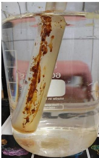
*F-7: In das gekühlte Reagenzglas laufende Pyrolyseöle*
