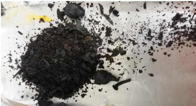
F-2: Bei der Durchführung mit hoher Aufheizrate und Temperatur entstandene tiefschwarze Kohle
