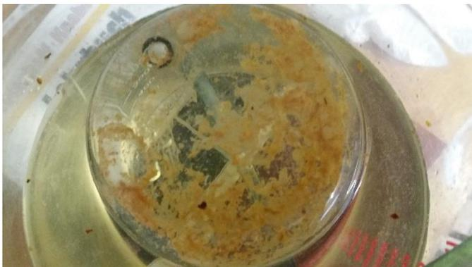
F-3: Dünne Partikelschicht auf der Wasseroberfläche im kleinen Becherglas
