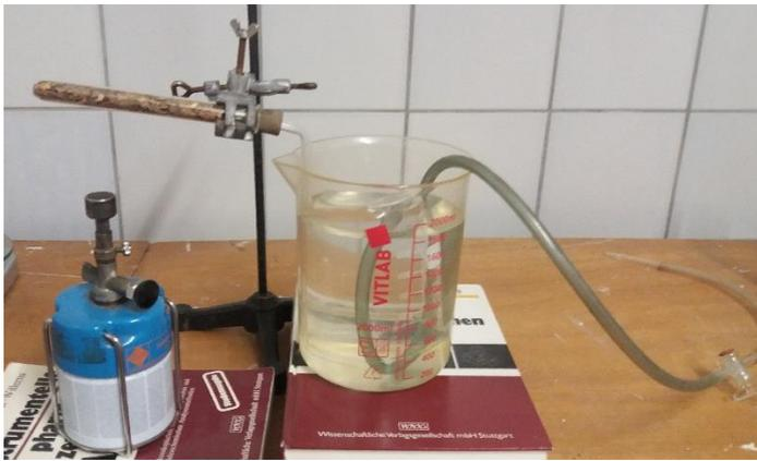
F-1: Versuchsaufbau zur Bestimmung der Gas- und Kohlemenge
