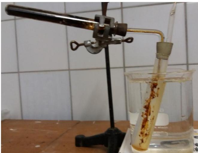
*F-6: Versuchsaufbau zur Bestimmung der entstehenden Flüssigkeitsmenge und Nachweis der Brennbarkeit des Pyrolysegases*
