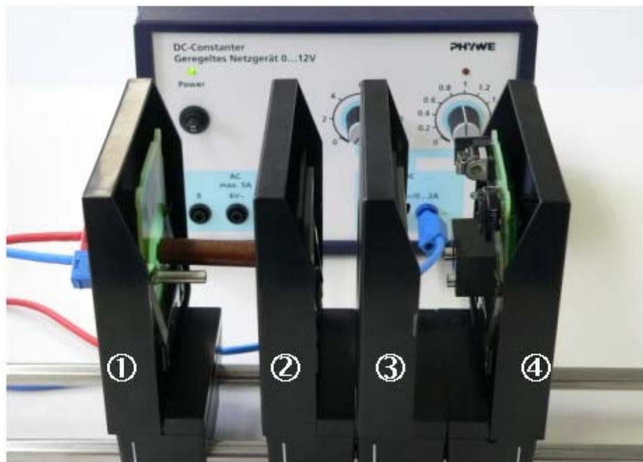
Abb. 1: Versuchsaufbau. Die LED mit Tubus ① strahlt auf die an Reiter ② festgeklebte Polarisationsfolie. Auf der Innenseite von ② sitzt die Lambda/4-Folie. Im Reiter ③ ist der 2. Polarisationsfilter (Analysator) aufgenommen. Die Fotodiode ④ misst die verbleibende Intensität des Lichts.
