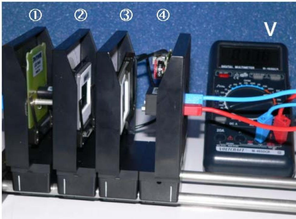
Abb. 1: Versuchsaufbau – Das Licht der LED ① tritt durch den ersten Polarisationsfilter ②, dann durch den 2. Polarisationsfilter ③ und wird dabei jedes Mal abgeschwächt. Die Intensität des Restlichts wird an der Fotodiode ④ gemessen.
